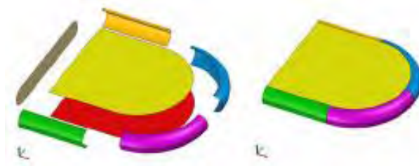
Рис. 1. BREP представление твердого тела
