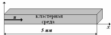
Рис. 1. Постановка трехмерных расчетов модельной задачи о пылении с гладкой поверхности однородного алюминиевого образца после выхода плоской УВ
