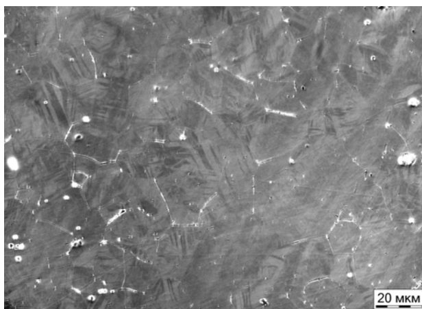
Рис. 4. Сплав U-Nb. Деформация 50 % + закалка от 700 °С. Поляризованный свет
