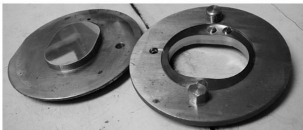
Рис. 8. Детали литейной формы
