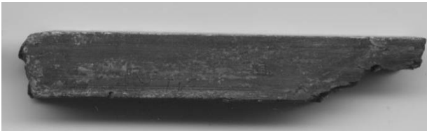
Рис. 5. Вид танталовой заготовки после 14 проходов РКУП при температуре 450 °С
