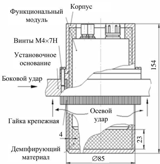
Рис. 2. Внешний вид (а) и конструкция (б) блока
