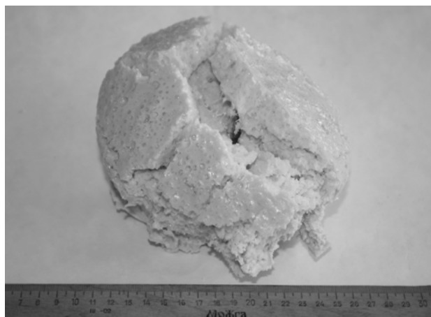
Рис. 8. Образец ППУ после воздействия ацетона
