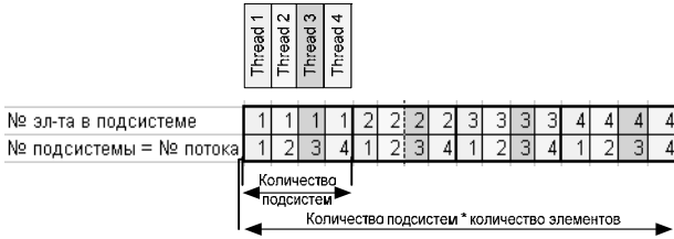
Рис. 1. Распределение матричных элементов в массиве для согласованного доступа к памяти: а – элементы подсистем; б – расположение элементов для согласованного доступа
