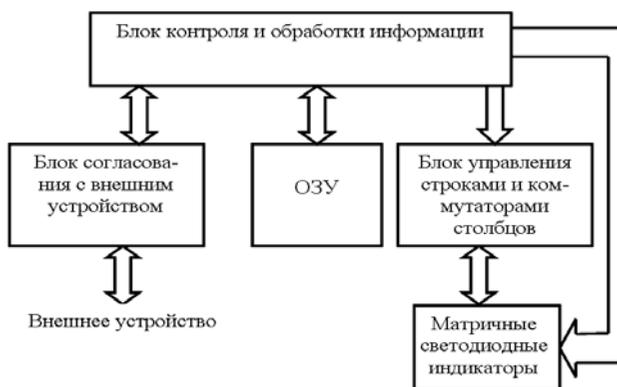
Рис. 1. Структурная схема дисплейного модуля
