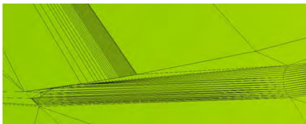
Рис. 10. Узкие вытянутые треугольники – главная особенность всех фасеточных поверхностей
