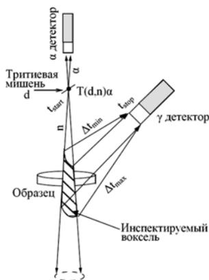
Рис. 1. Схема измерения мечеными нейтронами
