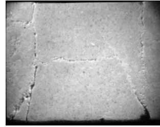
Рис. 5. Диаметральное сечение образца ВВ после опыта на локализованный сдвиг: опыт № 1, P = 31,4 \text{ кН} , \dot{\epsilon} = 200 \text{ с}^{-1} ( V_{\text{нагр.}} = 4,0 \text{ м/с} )
