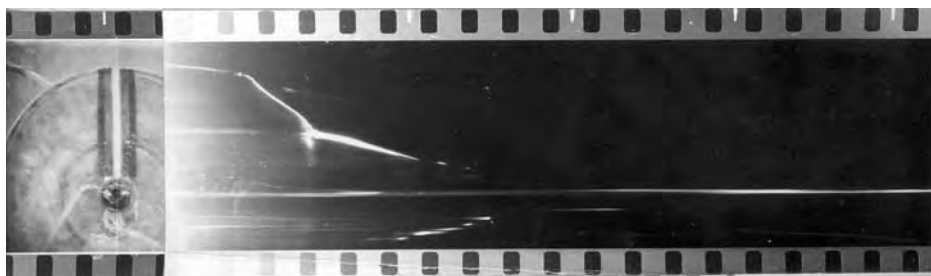
Рис. 14. Фотохронограмма полета тарели к отсечке с использованием прессованного ВВ
