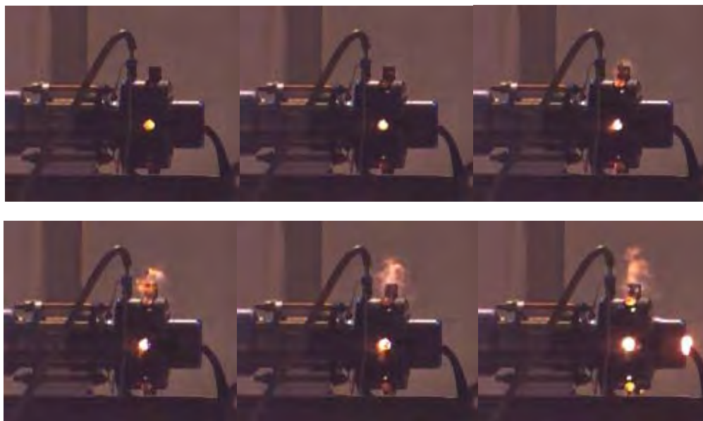
Рис. 7. Выход газов через отверстия в секции 2
