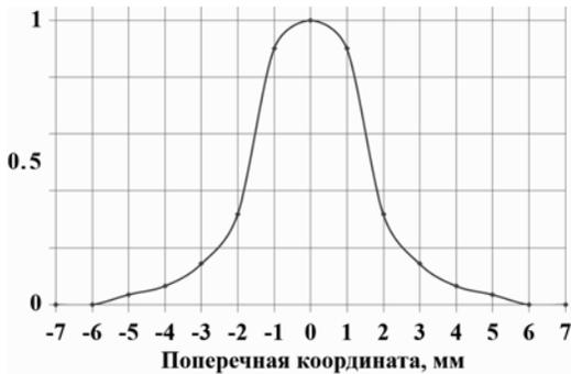
Рис. 12. Нормированное распределение квантов тормозного излучения
