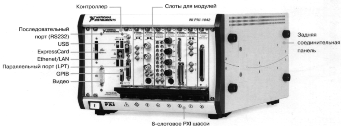
Рис. 1. Внешний вид (вид спереди) ПАИС на базе оборудования National Instruments
