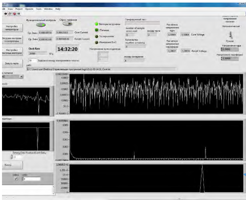
Рис. 5. Внешний вид главного окна управляющей программы во время исследования радиационной стойкости образца БМК при импульсном радиационном воздействии
