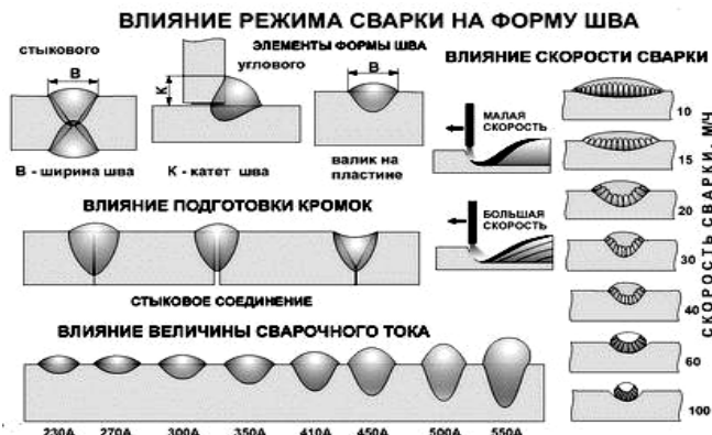
Рис. 1. Влияние скорости сварки на качество шва
