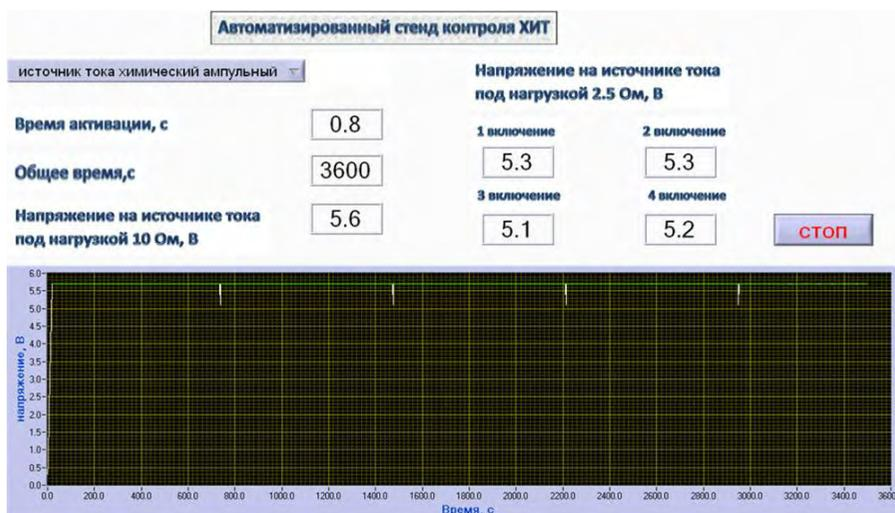
Рис. 4. Лицевая панель программы «Автоматизированный стенд контроля ХИТ (АСК ХИТ)». (Все параметры, приведенные на рис. 4 считать условными, так как настройка и отладка программы проводилась при использовании пробника источника тока)
