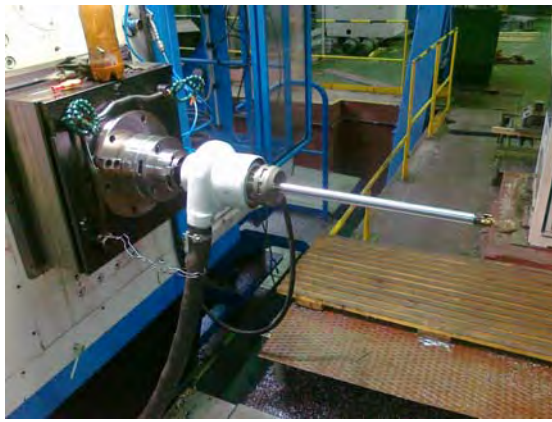
Рис. 2. Общий вид установки эжекторных сверл
