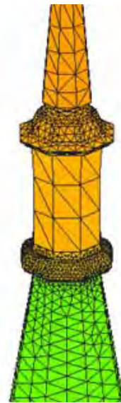
Рис. 14. Поверхностная сетка крыши здания, построенная с метриками, вычисленными с учетом искривления поверхности
