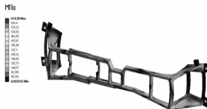
Рис. 5. Расчетное распределение внутренних напряжений от нагрузки
