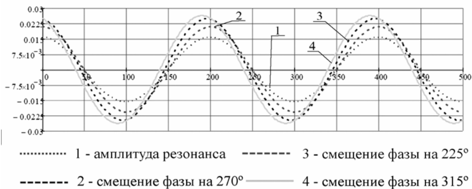
Рис. 8. График зависимости резонанса платы от смещения фазы одной из точек крепления от 180° до 360°
