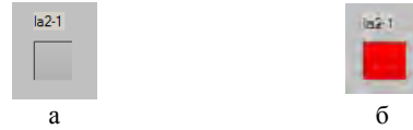
Рис. 7. Визуальный компонент – Дискретный датчик: а – состояние по умолчанию; б – состояние на заданное значение
