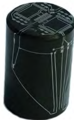
Рис. 6. Готовая деталь с нанесенным проводящим рисунком
