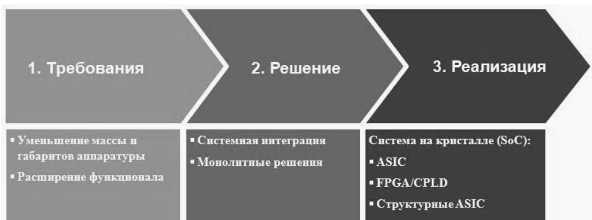
Рис. 1. Реализация требований к массогабаритным характеристикам при одновременном расширении функционала перспективной радиоэлектронной аппаратуры
