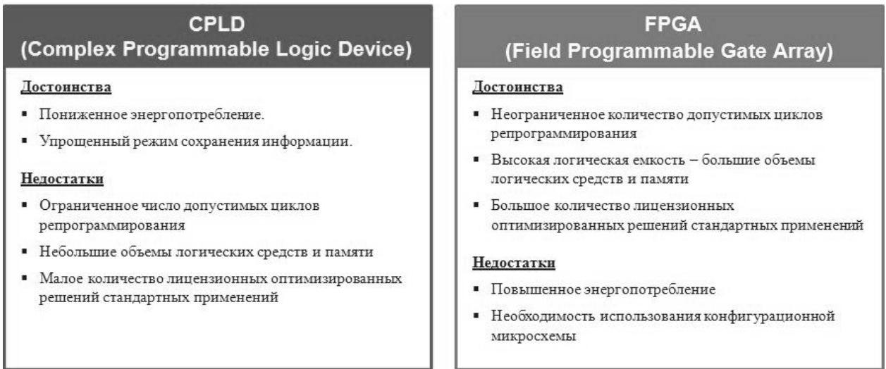
Рис. 7. Выбор ПЛИС для прототипирования
