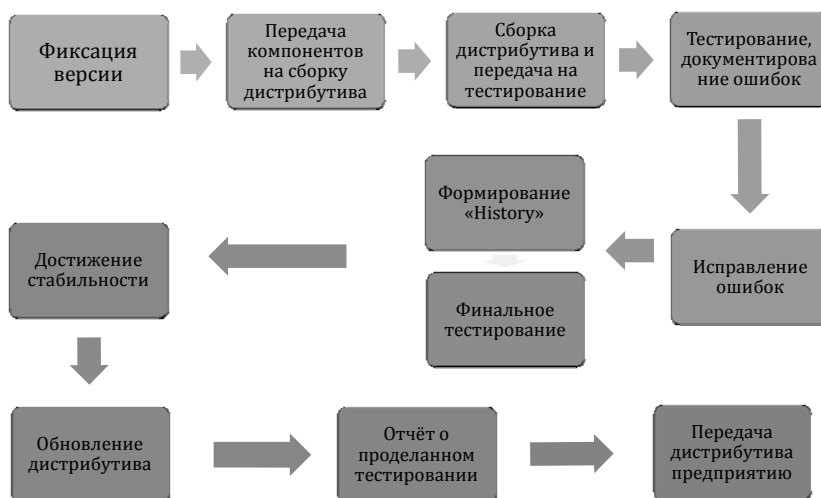
Рис. 1. Процесс подготовки версии комплекса ЛОГОС к выпуску
