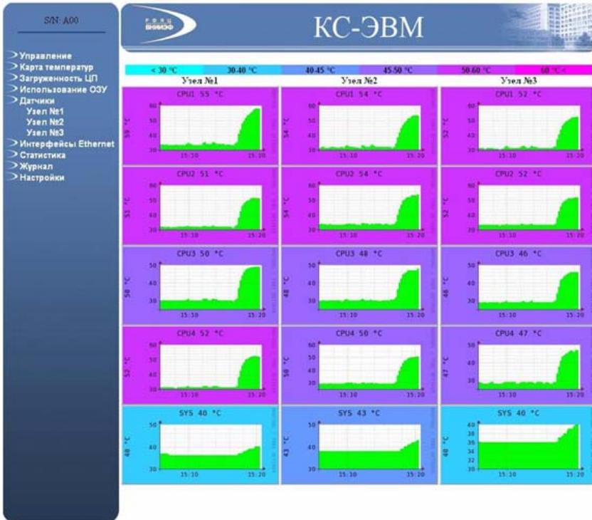
Рис. 13. Температура КС-ЭВМ во время теста Linpack
