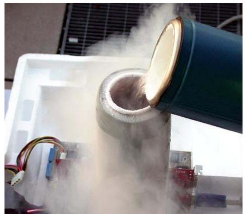
Рис. 3. Азотное охлаждение процессора
