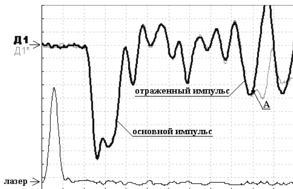
Рис. 3. Типичные осциллограммы импульсов напряжения на делителе Д1 при подаче основного лазерного импульса на фотокатод ФЭКа (Д1) и без его подачи (Д1*): лазер – пусковой импульс лазерного излучения. Зарядное напряжение генератора – 30 кВ, зазор в разряднике – 1,75 мм, давление в разряднике – 5,5 ати. Масштаб напряжения Д1, Д1* – 2 кВ/деление, масштаб времени – 5 нс/деление
