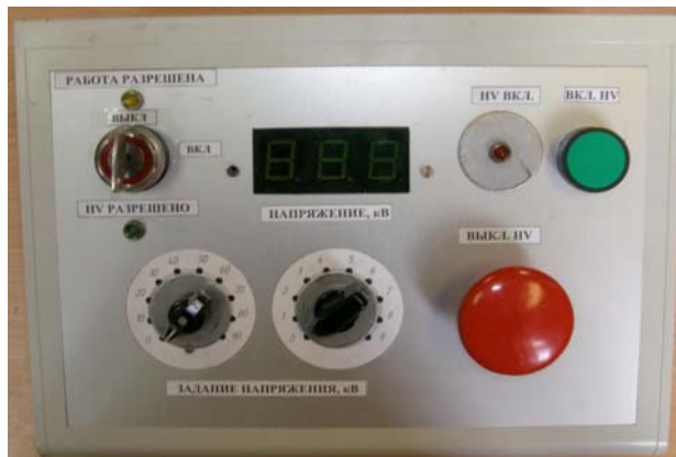
Рис. 4. Пульт управления стендом
