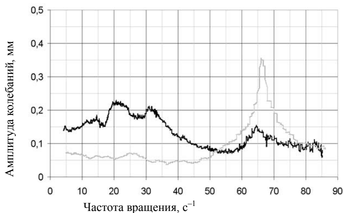
Рис. 7. Амплитуды колебаний ротора при вращении: — алгоритм включен; ..... — алгоритм выключен
