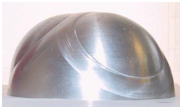
Рис. 9. Полуоболочка после испытания гидростатическим нагружением
