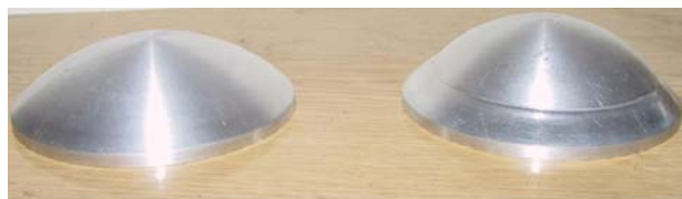
Рис. 8. Образцы в виде шарового сегмента из АМц до и после испытания
