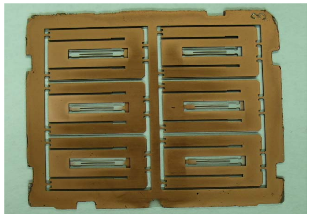
Рис. 6. Блок чувствительных элементов после плазмохимического травления
