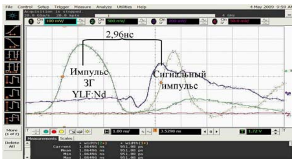
Рис. 8. Осциллограмма сигнального импульса и импульса 3Г YLF:Nd ( 1\omega ) в том же опыте
