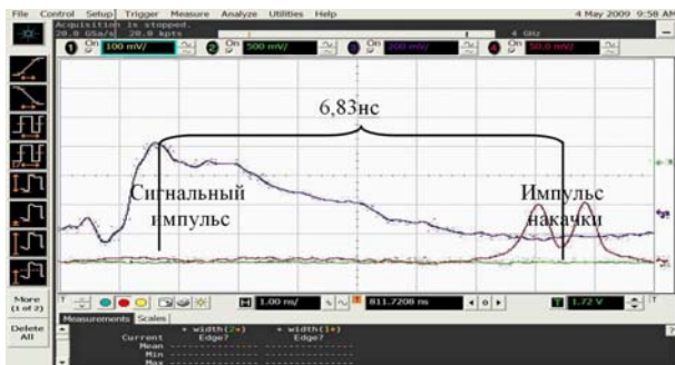
Рис. 7. Осциллограмма сигнального импульса и импульса накачки ( 2\omega ). Считаем данную синхронизацию импульсов по времени точной
