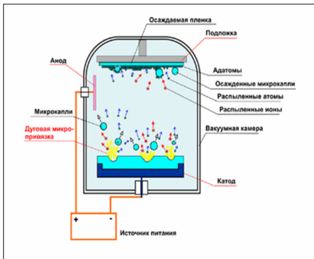
Рис. 1. Принципиальная схема нанесения покрытия методом вакуумного дугового напыления
