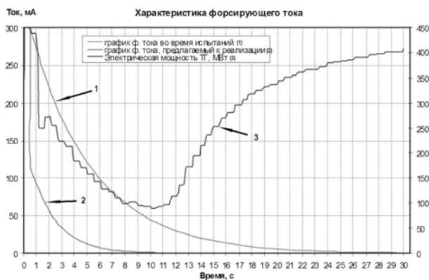
Рис. 1. График зависимости электрической мощности от импульса форсирующего тока на ЭГП при проведении испытаний режима «ИР 30 %» на уровне исходной мощности 450 МВт
