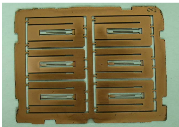
Рис. 6. Блок чувствительных элементов после плазмохимического травления
