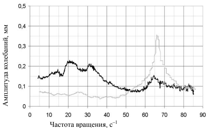
Рис. 7. Амплитуды колебаний ротора при вращении: — алгоритм включен; ..... — алгоритм выключен
