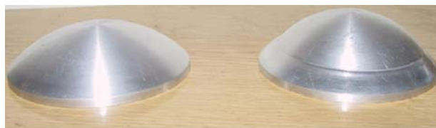
Рис. 8. Образцы в виде шарового сегмента из АМц до и после испытания
