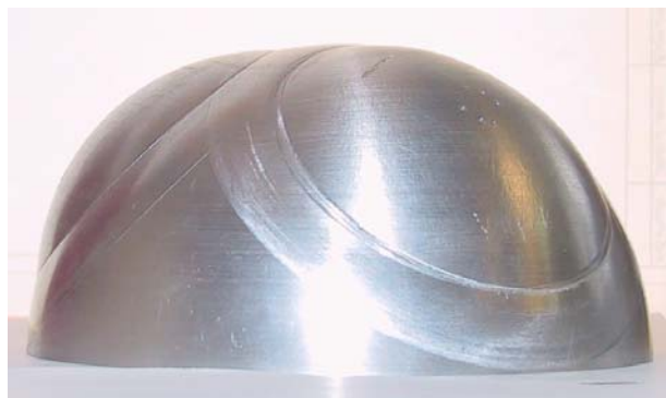
Рис. 9. Полуоболочка после испытания гидростатическим нагружением
