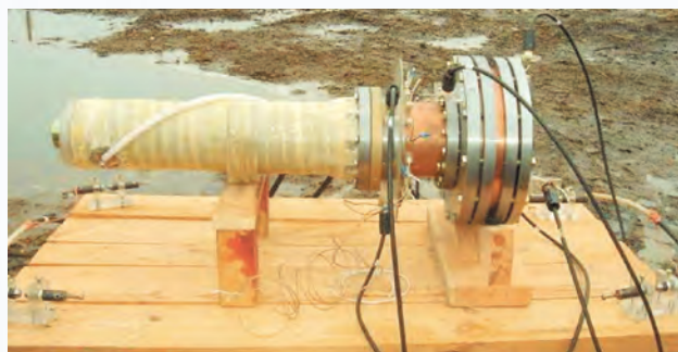
Рис. 3. Трехмодульный ДВМГ с преусилителем (слева) перед опытом
