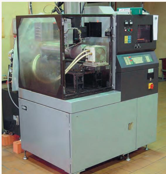
*Участок электроэрозионной обработки деталей*
