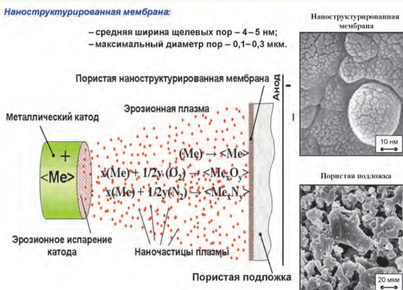
Рис. 8. Схема получения наноструктурных мембран
