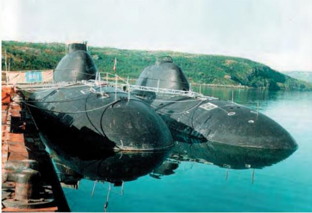
Рис. 2. Атомные подводные лодки проекта («Альфа») с реакторами со свинцово-висмутовым охлаждением (максимальная скорость под водой — 41 узел, экипаж — 29 чел.)
