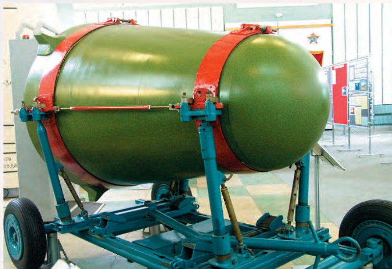
Термоядерный боевой блок для первой межконтинентальной баллистической ракеты Р-36 с разделяющей головной частью
