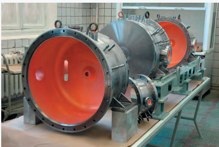
Сборка технологического прототипа ускоряющей структуры CSDTL в РФЯЦ-ВНИИТФ
