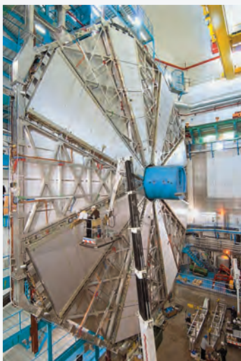
Сборка торцевых мюонных детекторов ATLAS в ЦЕРН. Опорные структуры («Большие колеса») разработаны в РФЯЦ-ВНИИТФ
