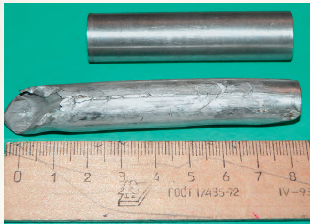
Рис. 7. Образец из алюминиевого сплава В95 до и после нагружения
