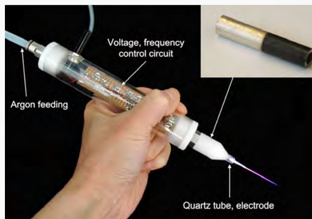
Рис. 6. Генератор плазменной струи и положение руки оператора во время процедуры
