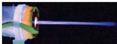
Рис. 7. Фотография игольчатой плазменной струи
