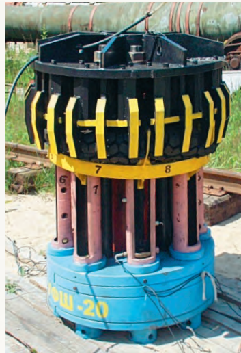
Рис. 8. Установка для фрагментации автомобильных шин и результат фрагментации
