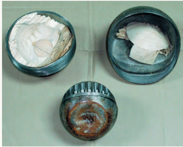
Рис. 10. Испытания транспортного контейнера: слева — до испытания, справа — после испытания
