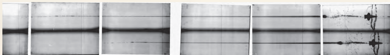
Рис. 2. Рентгенограммы кумулятивной струи на два момента времени, полученные в одном эксперименте (установка «2 Эридан-3»)
