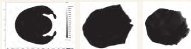
Рис. 7. Расчетная и экспериментальные рентгенограммы
