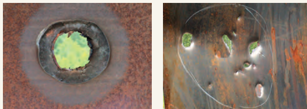
Рис. 8. Поражение бронепреграды (слева) и запреградного щита (справа)
