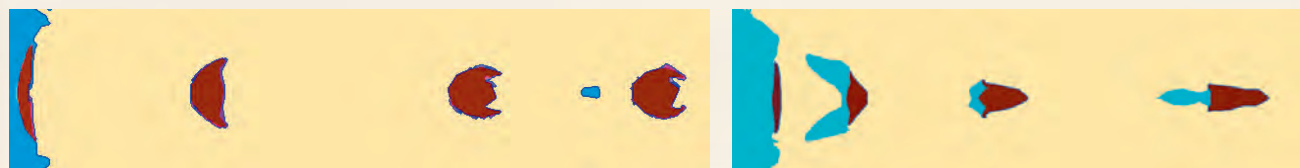
Рис. 6. Расчетное формирование поражающих элементов: слева — компактный, справа — удлиненный
