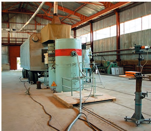
Транспортабельный нейтронный источник на основе «плазменного фокуса»
