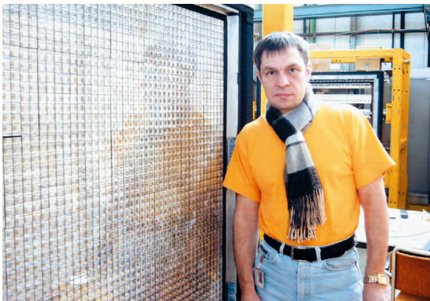
Модуль фотонного спектрометра PHOS (со снятой крышкой), разработанный в ИЯРФ. Справа — начальник группы ИЯРФ Д. В. Будников
