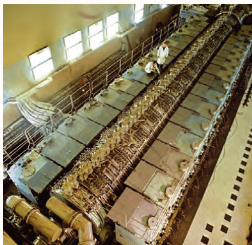
Базовая установка облучательного комплекса Пульсар — ускоритель ЛИУ-30
