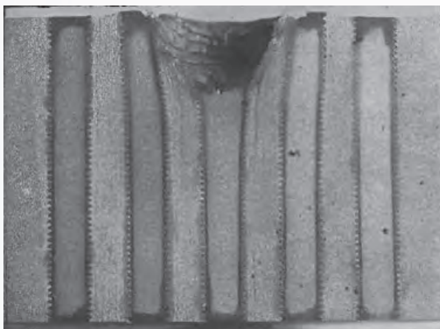
Опыт с болтом – доказательство пластической деформации металла преграды
