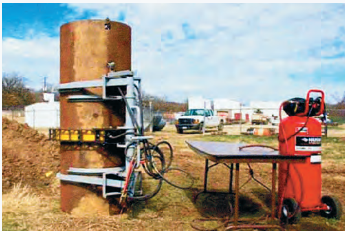
Взрывной резак в рабочем состоянии (масса ВВ – 6 кг)
