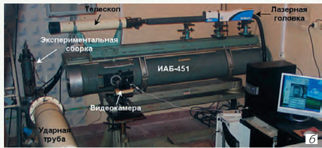
Рис. 1. Экспериментальные установки: а) канал ускорительный КУ-200 для исследования развития неустойчивости Рэлея–Тейлора на границе газ–жидкость (1 – драйвер; 2 – жидкость; 3 – подложка; 4 – секция измерительная; 5 – мембрана; 6 – фланец; 7 – подставка); б) измерительно-вычислительный комплекс
