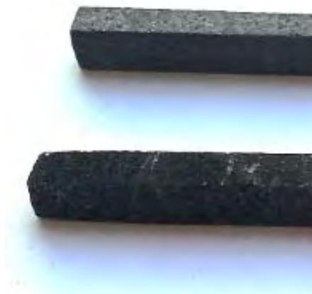
Рис. 5. Образцы графита РГТ до испытаний (верхний) и после испытаний
