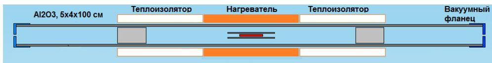
Рис. 2. Схема расположения элементов рабочей камеры установки исследования коррозии графитов на базе трубчатой печи GSL-1600
