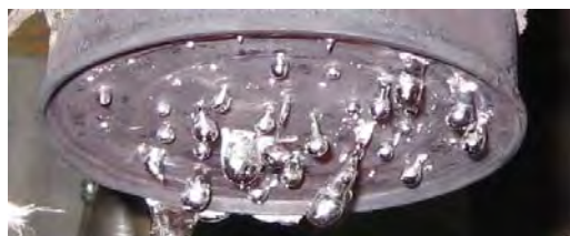
Рис. 7. Формирование капель расплава алюминия, содержащего порообразователь, на выходе из гранулятора (источник: ОАО «ВИЛС», Россия)
