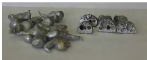
Рис. 8. Гранулы алюминия, содержащие порообразователь, после их охлаждения: слева – плотные, до вспенивания, справа – пористые, после вспенивания
