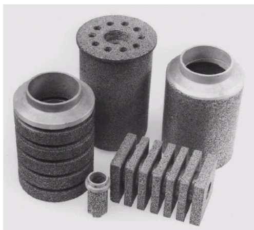
Рис. 2. Образцы деталей, изготовленных с использованием алюминиевых пен [2]. Компактные части деталей образуют композитную конструкцию, содержащую детали из пеноматериала. Высота самой длинной из представленных деталей ~130 мм (источник: Fraunhofer – Institute, Germany)
