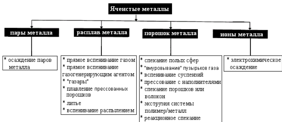
Рис. 3. Классификация различных методов получения металлических пен по состоянию металла, в котором происходит его обработка (схема заимствована из [2])
