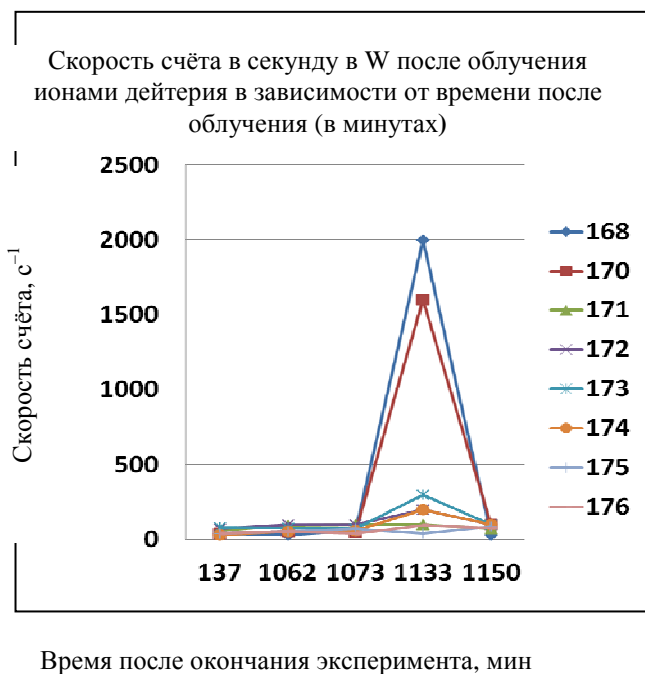
Рис. 9. Интенсивность счёта в масс-спектрах для более лёгких изотопов, чем известные изотопы вольфрама после прекращения облучения ионами дейтерия
