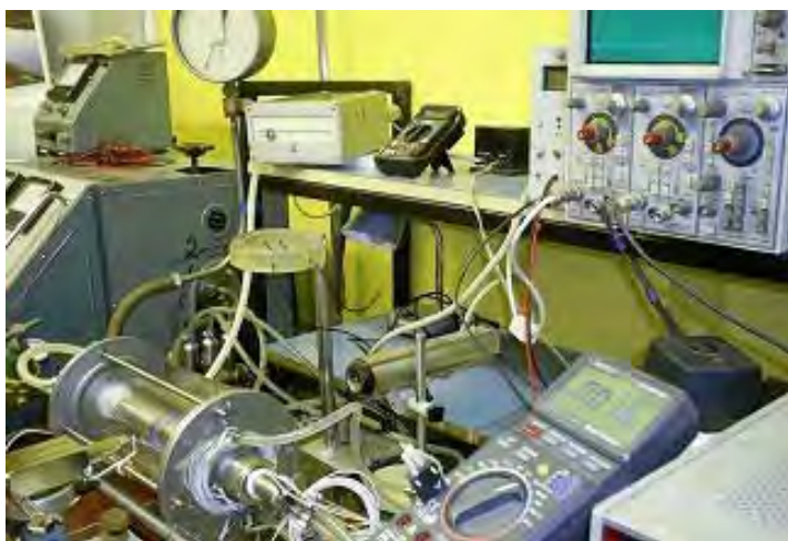
Рис. 3. Газоразрядная камера с CdTe гамма-детектором [25]
