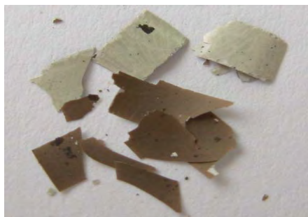
Рис. 1. Вид оксидной плёнки, отделённой от металла химическим способом
