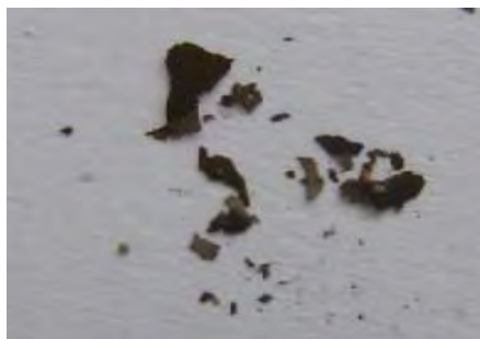
Рис. 1. Вид оксидной плёнки, отделённой от металла химическим способом
